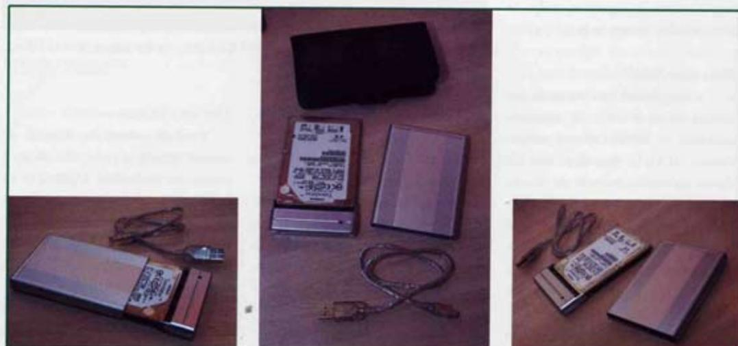
Utilizando una caja externa USB miniatura para convertir un disco duro de 3,5 pulgadas, en un disco externo autónomo.
