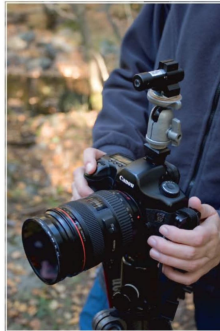
Un puntero láser montado sobre una pequeña rótula y acoplado a la zapata de la cámara ayuda a enfocar con mucha facilidad en la oscuridad.
